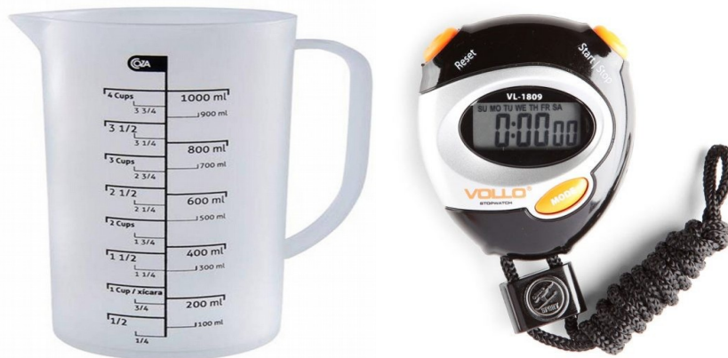
Figura 1: Equipamentos usados para medir vazão: recipiente de 1litro e cronometro.
